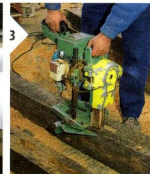
**3** Les mortaises sont « descendues » avec une mortaiseuse à chaîne, engin très efficace pour creuser profondément.
