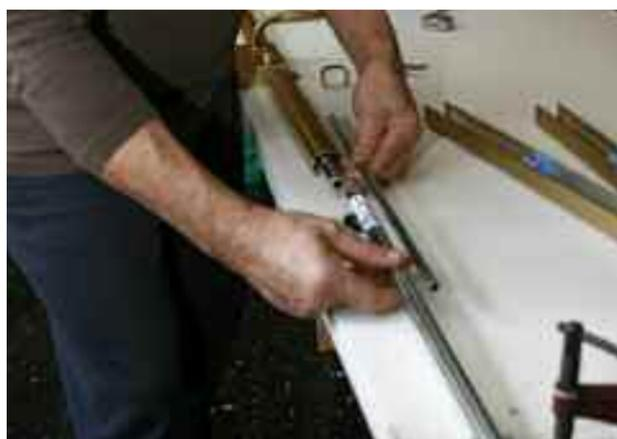
**22** Le réglage nécessaire de la longueur des tringles se règle grâce à un tube diamètre 10mm que l'on rentre dans chaque paires de tringles hautes et basses.
