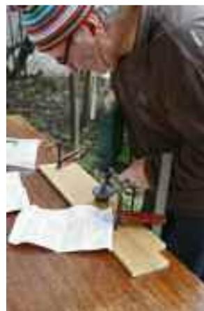
**6-7** Le gabarit du mode d'emploi permettra de localiser les trous avec précision. Bien fixer le manche démontable servant de guide à la perceuse, les vibrations provoquées par la scie cloche sont fortes.
