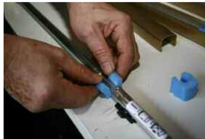
**24** Des morceaux de mousse très dense fournis doivent être placés au niveau des tringles intermédiaires, ils en permettront le guidage.
