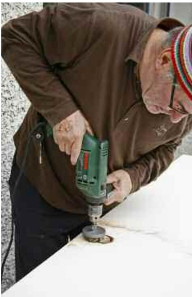
**8** Pour réaliser une bonne finition lorsque l'on ménage un trou avec une scie cloche, il est conseillé de retourner la pièce à percer puis de finir le trou par l'autre côté. On se reprend sur le trou central au foret et les bords sont parfaits des deux côtés.
